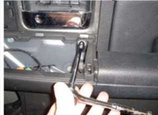
2) remove 10 mm bolt
