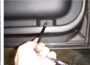
9) remove 2ea 6 mm on bottom of door
