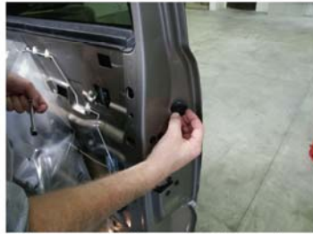
14) remove rubber plug from door
