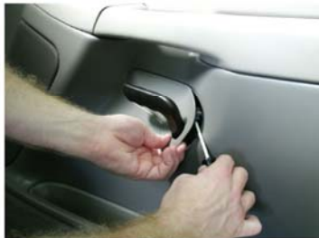
4) remove handle bezel
