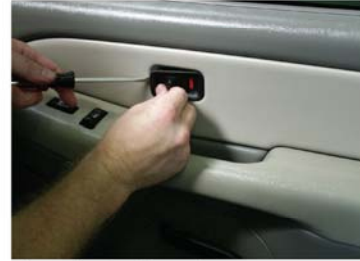
3) unclip lock bezel
