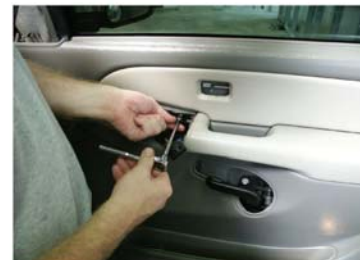
9) remove upper door panel bolt
