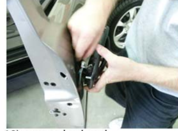
18) remove latch rod, quick (dis)connect
